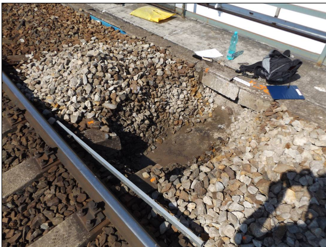
Obr. č. 6 - kopaná sonda KS2
